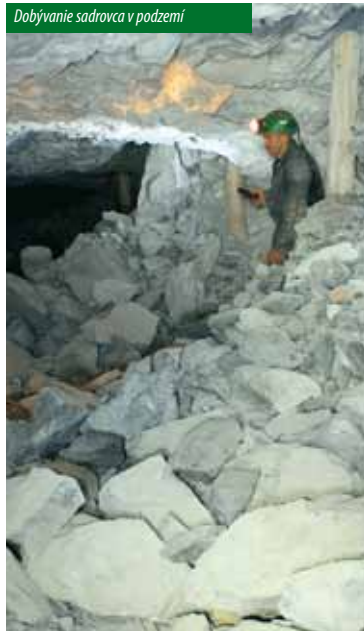
Dobývanie sadrovca v podzemí
